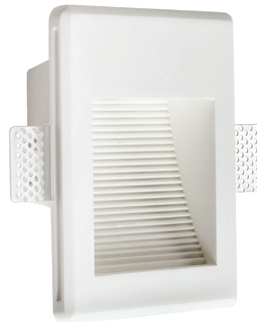
Επίτοιχο / Wall luminaire Γύψος / Gypsum Φυσικό / Natural 142xH170mm G8001MR00500 1xMR11 max 35W G8001LED01050 LED 60° 1.5W 3000K 150Lm
